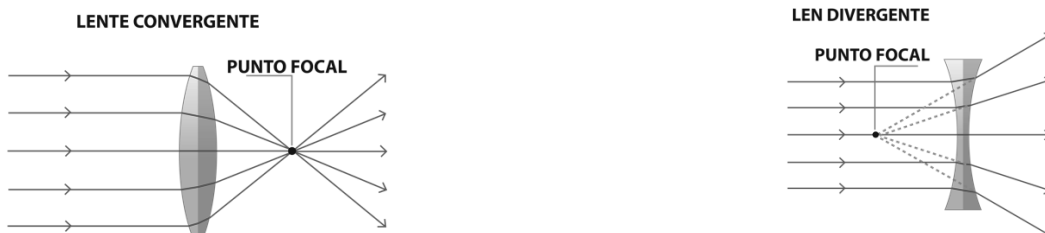
Figura 3: Las líneas rojas representan rayos de luz. En la lente convergente se aprecia cómo la luz se concentra en un punto llamado punto focal o foco . En la lente divergente se aprecia cómo las líneas son separadas o dispersadas al pasar a través de él
