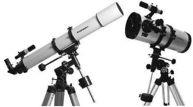
Figura 5: Dos tipos básicos de telescopios. A la izquierda: un telescopio refractor que usa lentes convexas; y a la derecha, un telescopio reflector que usa la combinación de espejo cóncavo y lentes convexas
